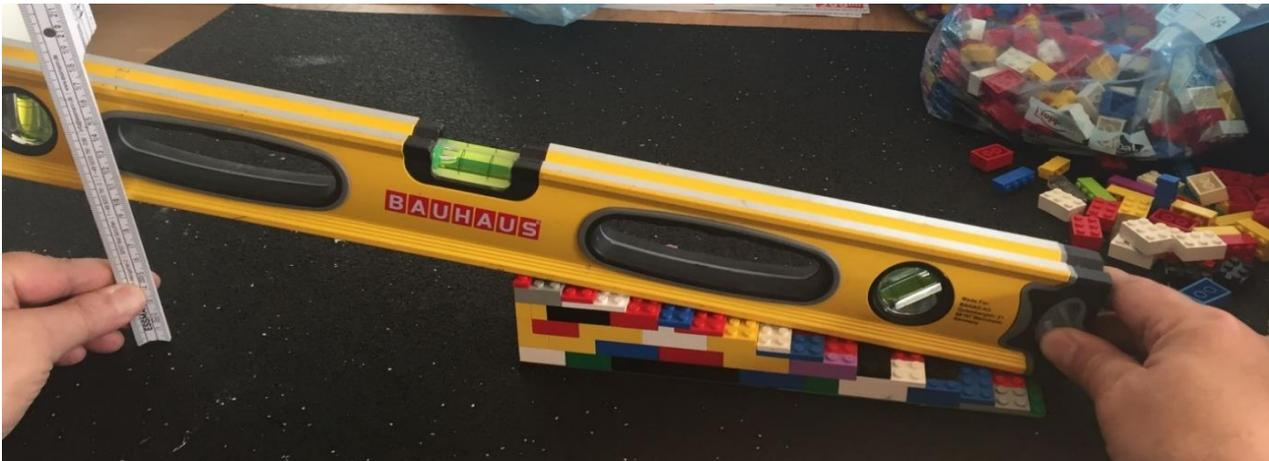
**Wichtig!** In der Höhe der fertigen Rampe immer etwas unter der Stufenhöhe bleiben, damit man beim darüber laufen nicht hängen bleibt. Wir legen die Rampe immer noch mal an die Stufe, bevor die letzten Steine verklebt werden.
